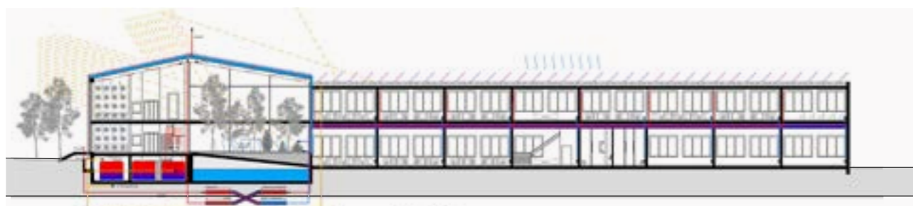
152 Heizungs-, Kühlungs- und Lüftungskonzept (ohne Maßstab)
